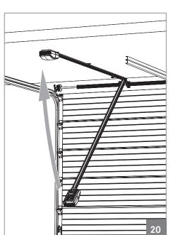
04 • Suba el motor hasta que la guía quede nivelada horizontalmente.
